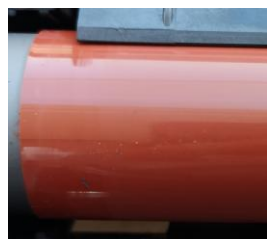
Сепарационная пластина царапает вал
